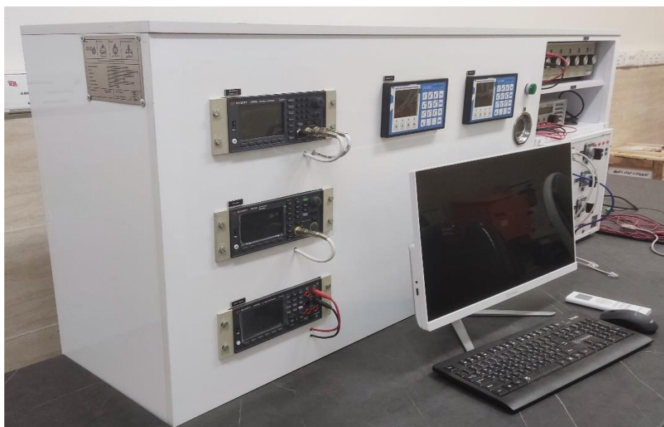
تصویری از پنل تست دقت فلوکامپیوتر
