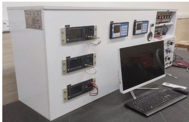
شکل ۱: تصویری از پنل آزمون دقت فلو کامپیوتر مستقر در فضای آزمایشگاهی انستیتو اندازه‌گیری هوشمند گاز
