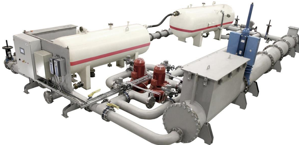
شکل ۱: شماتیکی از آزمایشگاه فلولوپ هوای فشرده جهت صحت‌سنجی کنتورهای سائز پایین و متوسط
